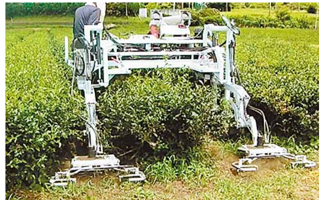
管理機に除草機を装着する構造
